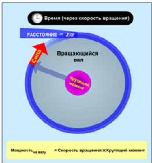
Рисунок 13-8: Мощность на валу, выраженная в произвольных единицах; источник: craig.backfire
