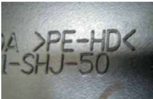
Рисунок 13-25: Пластиковая часть интерьера имеет маркировку PE-HD , что означает полиэтилен высокой плотности; источник: Pearson Education, Inc
