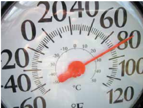
Рисунок 13-19: Типичный термометр наружного воздуха, который в настоящий момент указывает умеренно теплую температуру воздуха (около 27^{\circ}\text{C} или около 80^{\circ}\text{F} ); источник: Pearson Education, Inc
