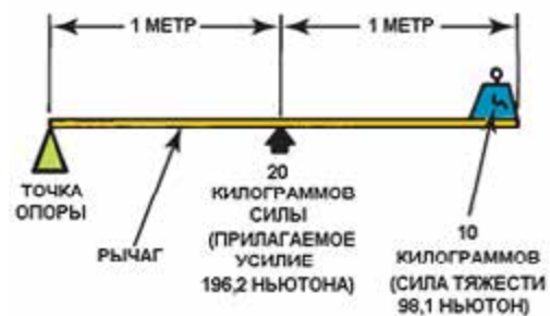
Рисунок 13-17: Рычаг третьего рода увеличивает прилагаемое усилие, но увеличивает скорость перемещения груза и пройденное грузом расстояние; источник: Pearson Education, Inc
