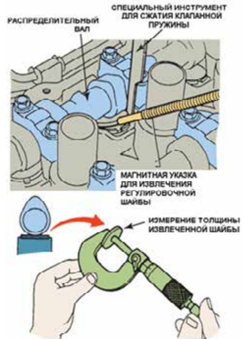
Рисунок 14-2: Процедура извлечения и измерения регулировочной опорной шайбы в приводе клапана; источник: Pearson Education, Inc.
