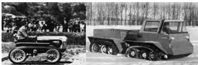
Рисунок 3. Однополостные пневмогусеницы: а — на тракторе Д. Бонмартини; б — на опытном образце НАМИ-0106
