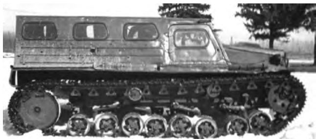
Рисунок 2. Ходовой стенд ОНИЛВМ НГТУ на шасси ГАЗ-47
