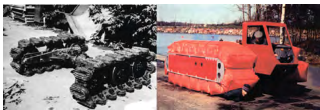
Рисунок 4. Пневмотраковый движитель: а — движитель НАМИ-СЗМУ; б — движитель финской фирмы Keksintosaatio
