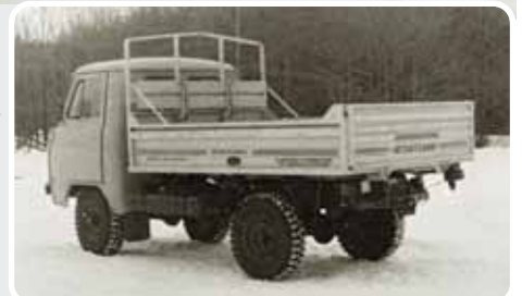
Второй опытный образец самосвала получил официальный индекс УАЗ-САЗ-2923 (март 1994 г.). Хорошо видны откидная лавка для пассажиров и дуга безопасности у переднего борта платформы. Кстати, данный автомобиль до сих пор работает в ОАО «САЗ»
