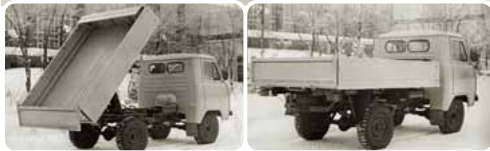
Макетный образец УАЗ-САЗ-3515, декабрь 1993 г. Особенности машины – борта платформы равной высоты с внутренним расположением усилительной обвязки
