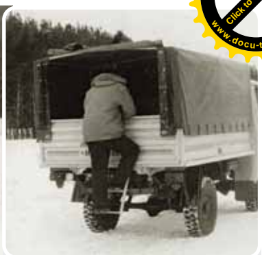
УАЗ-САЗ-2923 с тентом. Для удобства доступа в кузов предусматривалась выдвигная лестница
