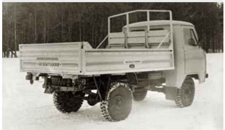
Второй опытный образец самосвала получил официальный индекс УАЗ-САЗ-2923 (март 1994 г.). Хорошо видны откидная лавка для пассажиров и дуга безопасности у переднего борта платформы. Кстати, данный автомобиль до сих пор работает в ОАО «САЗ»
