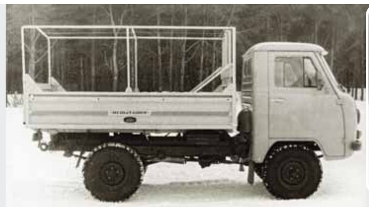
УАЗ-САЗ-2923 с установленным каркасом тента
