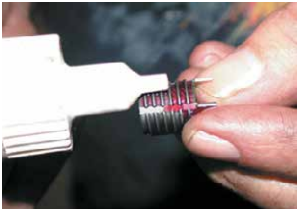
Рисунок 8-33: Нанесите небольшое количество фиксирующего компаунда на внешнюю резьбовую поверхность вставки; источник: Pearson Education, Inc.
