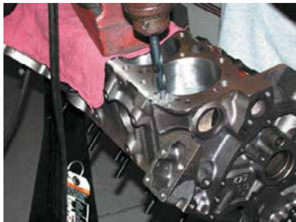
Рисунок 8-29: Высверлите поврежденную резьбу сверлом, поставляемым в комплекте вместе с твердо-втулочными вставками; источник: Pearson Education, Inc.
