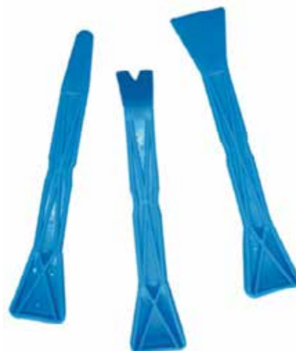
Рисунок 8-18: Пластиковые или металлические инструменты, предназначенные для снятия дверных панелей и других элементов интерьера, позволяют технику снимать эти элементы, не нанося им вреда; источник: Pearson Education, Inc.
