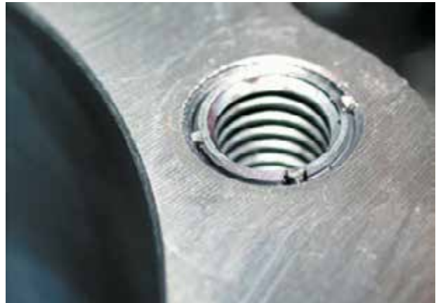
Рисунок 8-35: Резьбовая вставка и фиксирующие замки вкладыша должны находиться ниже поверхности ремонтируемой детали; источник: Pearson Education, Inc.
