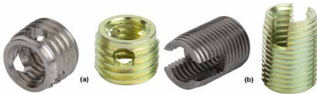
Рисунок 8-26: Твердые самонарезающие вставки бывают двух типов: (a) стружка удаляется через боковые отверстия; (b) с усеченными начальными витками резьбы и двумя или тремя угловыми пазами, которые обеспечивают процесс резания; источник: Baer-Fix®
