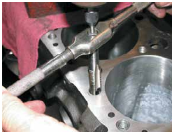
Рисунок 8-30: Используйте специальный метчик для нарезания резьбы в ремонтируемом отверстии; источник: Pearson Education, Inc.
