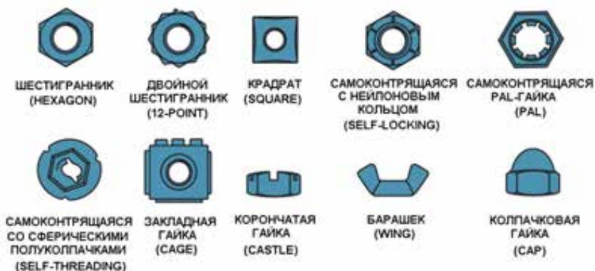
Рисунок 8-21: Все приведенные на рисунке гайки могут использоваться как в роли крепежных элементов, так и в роли контргайек, навинченных поверх основной гайки для защемления витков резьбы, и препятствующих самопроизвольному ослаблению крепежа от вибрации; источник: Pearson Education, Inc.
