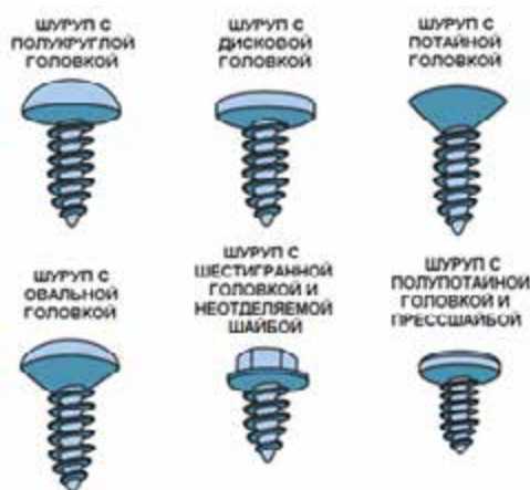
Рисунок 8-14: Шурупы, или как ещё их называют, винты для скрепления листовых материалов могут иметь различные формы головок; источник: Pearson Education, Inc.
