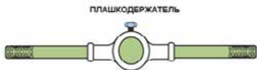
Рисунок 8-11: Плашкодержатель используется для фиксации плашки при нарезании наружной резьбы на стержне; источник: Pearson Education, Inc.
