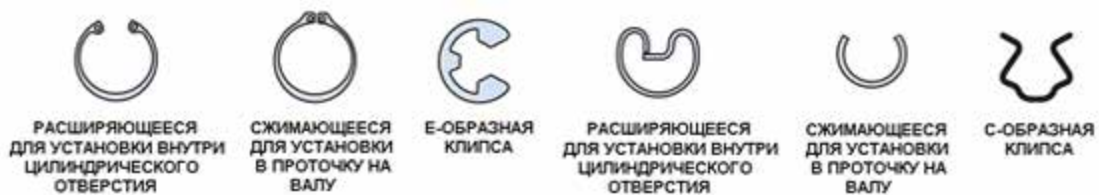
Рисунок 8-16: Несколько различных типов стопорных колец. Внутреннее стопорное кольцо устанавливается внутри корпуса или отверстия в паз. Внешнее стопорное кольцо вписывается в паз, выполненной на наружной поверхности вала или оси. Е-зажим помещается в паз в наружной части вала. С-образный зажим, показанный на рисунке, используется, чтобы удерживать рукоятку стеклоподъемника на его валу; источник: Pearson Education, Inc.
