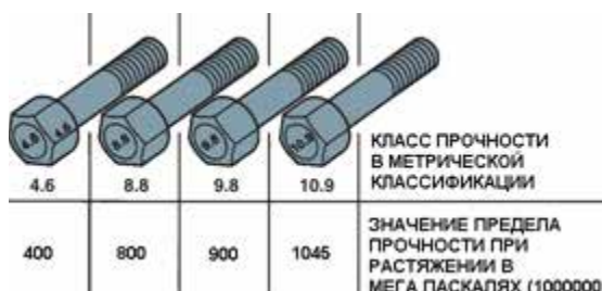
Рисунок 8-5: Пример обозначения класса прочности метрических болтов и таблица максимальных значений разрушающей нагрузки для метрических болтов. Предел прочности материала получается делением максимальной разрушающей нагрузки на рабочую площадь поперечного сечения; источник: Pearson Education, Inc.
