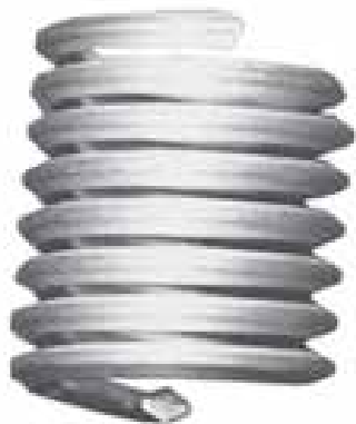
Рисунок 8-23: Спиральные вставки похожи на маленькие, витые пружины. Наружная часть вставки является резьбой, которая удерживает спираль в ремонтируемом отверстии, а внутренняя часть спирали является резьбой, которая соответствует нужной резьбе крепежной детали; источник: Pearson Education, Inc.
