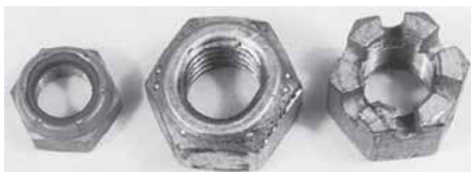
Рисунок 8-6: Виды контргайк. Слева – гайка с запрессованным нейлоновым кольцом; в центре – гайка с деформированными витками резьбы; справа – корончатая гайка, фиксация которой производится посредством шплинта, вдеваемого в отверстие в теле болта; источник: Pearson Education, Inc.
