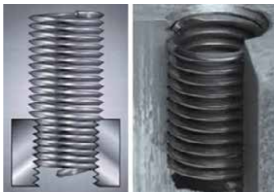
Рисунок 8-24: Спиральная вставка обеспечивает формирование в отверстии новой резьбы, которая позволяет использовать оригинальные крепежные детали; источник: Heli-Coil-Colombia
