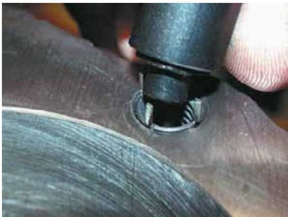
Рисунок 8-34: Используйте направляющий инструмент для заглубления фиксирующих клавиш в пазы резьбовой втулки; источник: Pearson Education, Inc.
