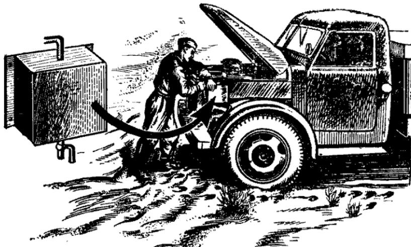
Рис. 52. Конденсационный бачок и место установки его на автомобиле ГАЗ-51
