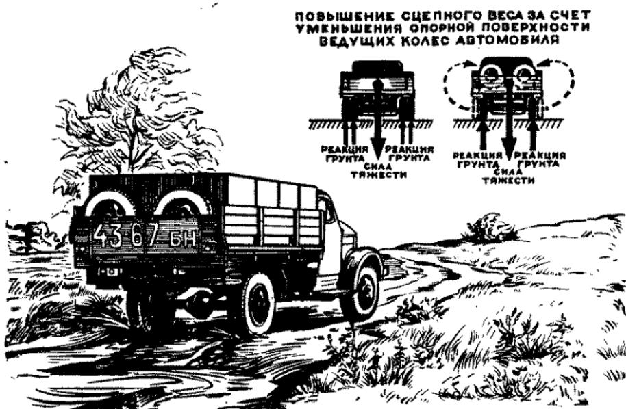
Рис. 15. Повышение сцепного веса за счет уменьшения опорной поверхности ведущих колес
