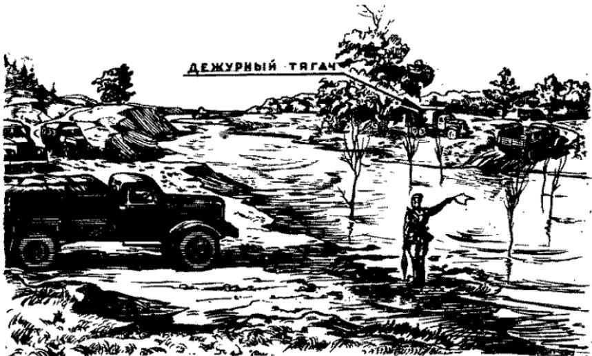
Рис. 31. Организация и регулирование переправы автомобилей вброд
