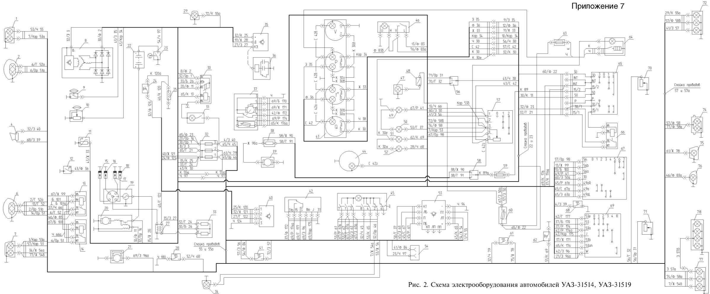
Рис. 2. Схема электрооборудования автомобилей УАЗ-31514, УАЗ-31519
