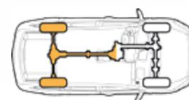
Крутящий момент двигателя передается только на задние колеса, позволяя экономить топливо при езде в нормальных условиях
