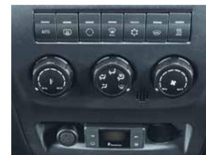
Блок управления системой кондиционирования и отопления
